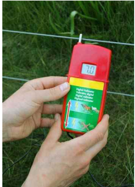
Digital-Voltmeter zur Messung der Hütесіspannung.
