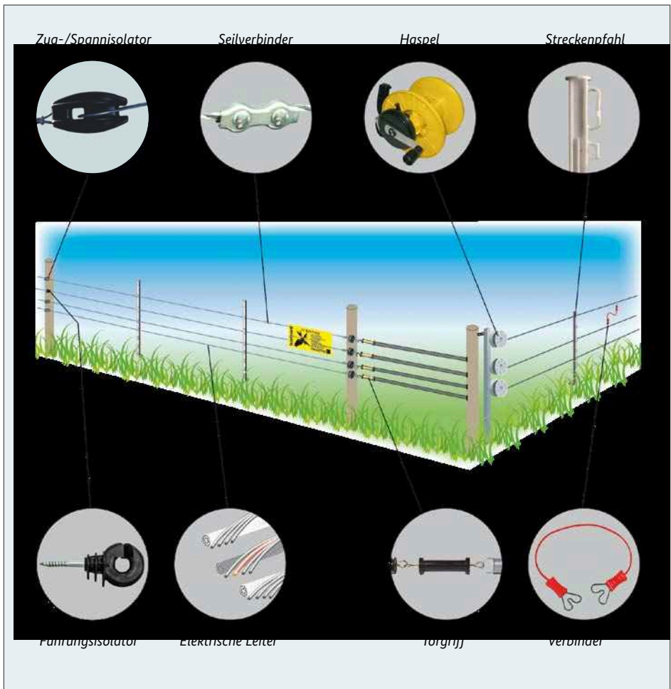
Abbildung 7: Beispiel für einen Elektrozaun (symbolhafte Darstellung der Zaunkomponenten).
